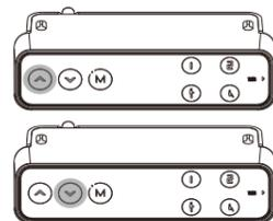
上ボタン・下ボタンを押し続けてデスクを昇降します。LED画面にデスクの高さを表示します。
