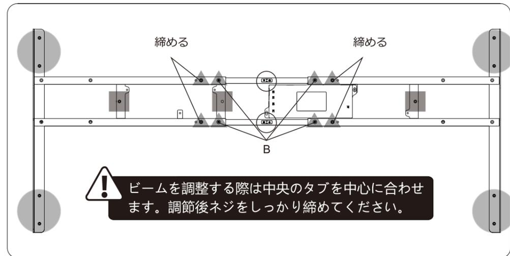
**!** ビームを調整する際は中央のタブを中心に合わせます。調節後ネジをしっかり締めてください。
