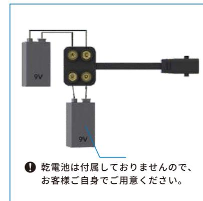
2. 9V電池2枚を電池ボックスに入れます。新旧・異なる銘柄・違う種類の電池を混用しないようご注意ください。
