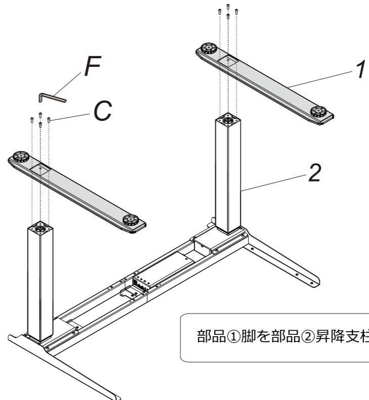
部品①脚を部品②昇降支柱に取り付けます。
