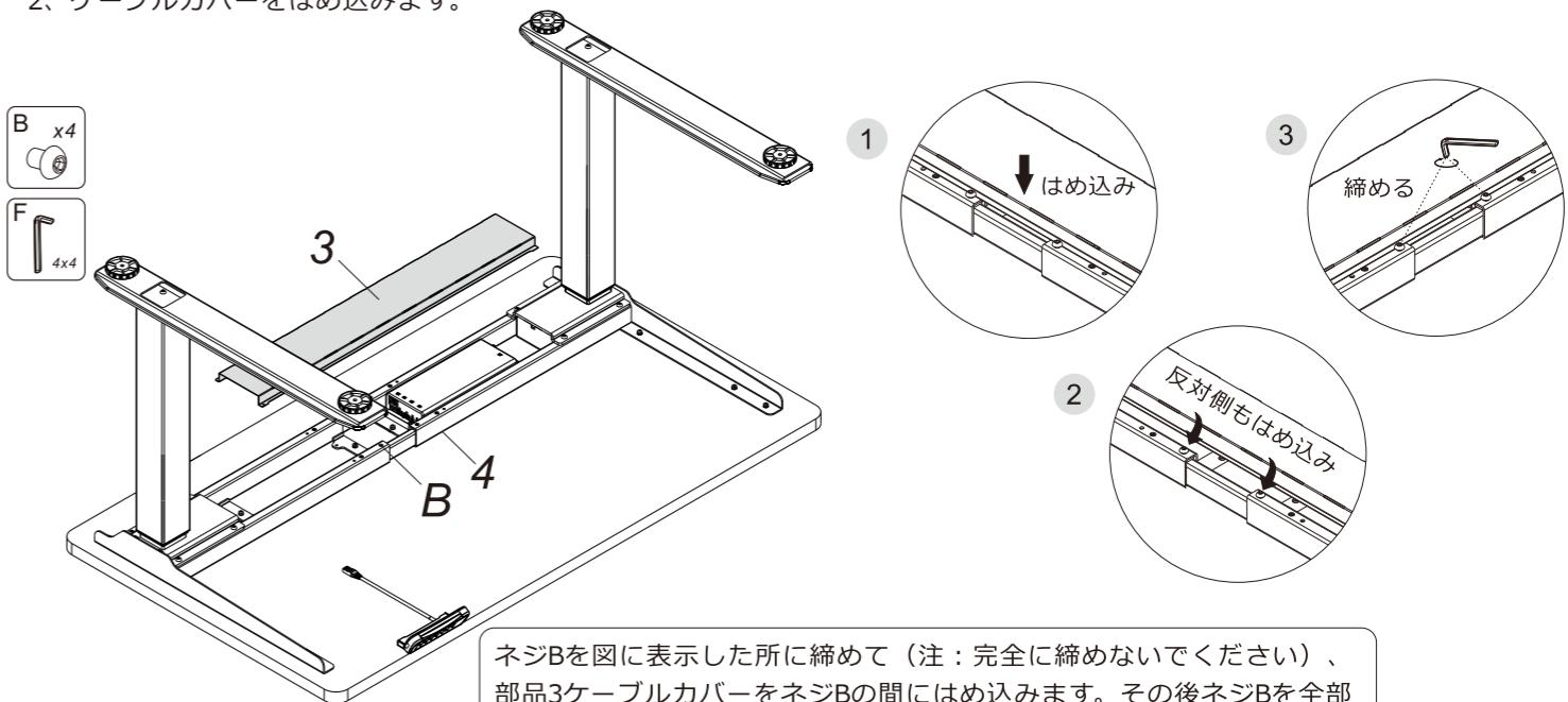
ネジBを図に表示した所に締めて（注：完全に締めないでください）、部品3ケーブルカバーをネジBの間にはめ込みます。その後ネジBを全部締めます。
