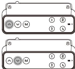
上ボタン・下ボタンを押し続けてデスクを昇降します。LED画面にデスクの高さを表示します。
